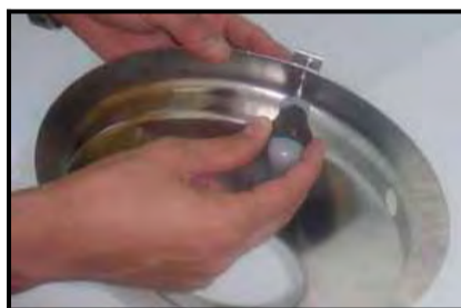
13 - Βιδώστε τον συνδετήρα στο άνω τμήμα
