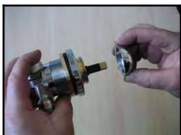
29 - Ξεβιδώστε το κάλυμμα του επιχρωμιωμένου περικόχλιου
