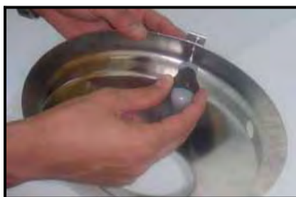
13 - Βιδώστε τον συνδετήρα στο άνω τμήμα
